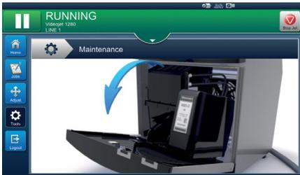
Videojet Smart Cartridge™ 系统无脏乱、无浪费、无错误，可排出墨盒/溶剂盒中的所有墨水/溶剂，并且在运输和处理过程中提供额外的防泄漏保护。Videojet SmartCell™ 设计还可简化日常维护。
